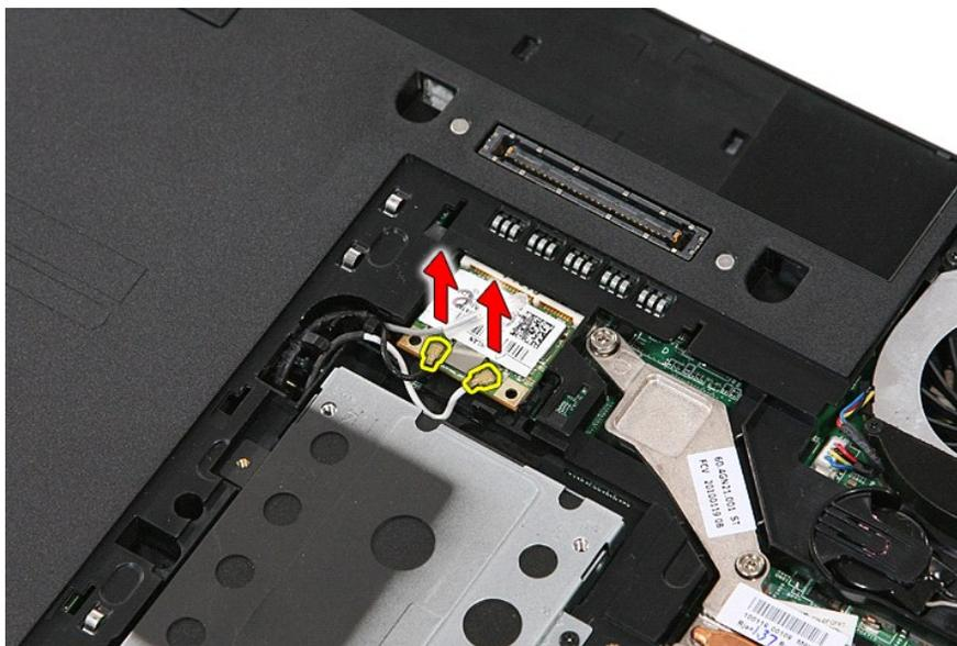
5. Sollevare delicatamente, facendo leva, il dispositivo di chiusura per sbloccare la scheda WLAN.
