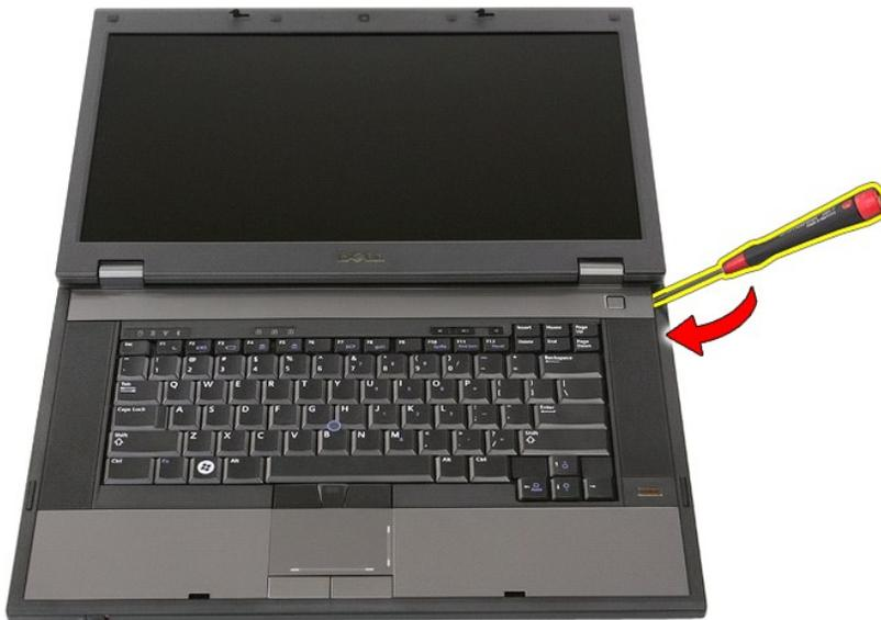
4. Sollevare delicatamente, facendo leva, lungo il bordo del coperchio dei LED per sbloccarlo dai dispositivi di chiusura e rimuoverlo.
