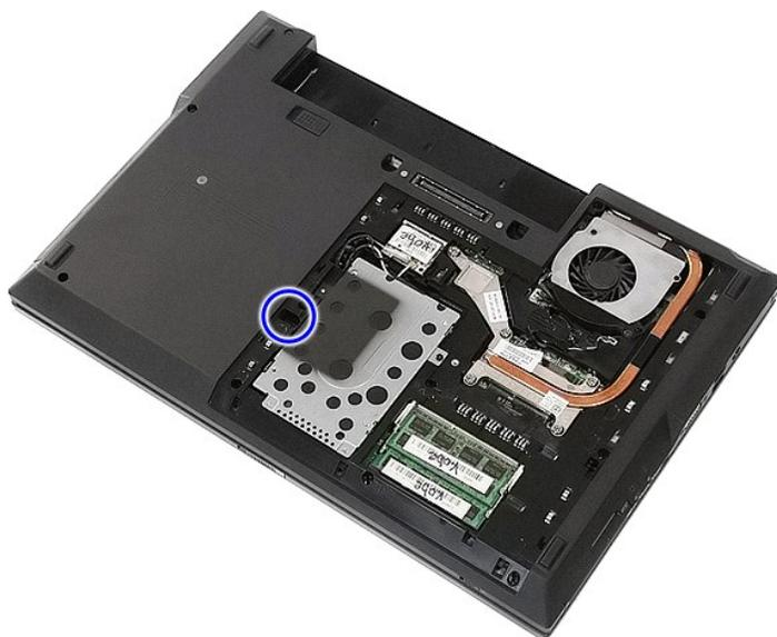
4. Inserire un cacciavite di plastica nella scanalatura della vite di contenimento e sganciare e rimuovere con attenzione l'unità ottica dal computer.
