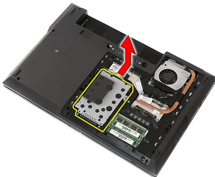
6. Rimuovere le viti che fissano il compartimento dischi del disco rigido al disco rigido.
